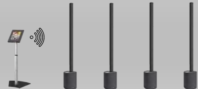
Eksempel på kabelfrit system for lounge/baggrundsmusik hvor alt styres fra en iPad.
